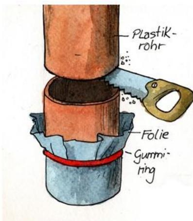
1. Zuerst brauchst du ein Plastikrohr. Geeignet sind Wasserrohre oder die Fallrohre von Regenrinnen. Das Rohrstück sollte etwa 25-30 cm lang sein. Mit einer Säge kannst du das Rohr zurechtschneiden.
